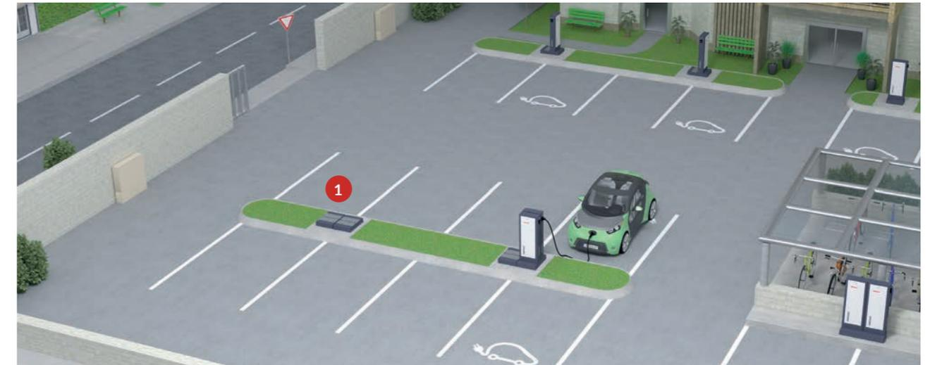
Dans cet exemple, nous voyons certaines places équipées de points de recharge et d'autres non, mais toutes ont au minima des socles enterrés surmontés de couvercles de mise en attente 1.
